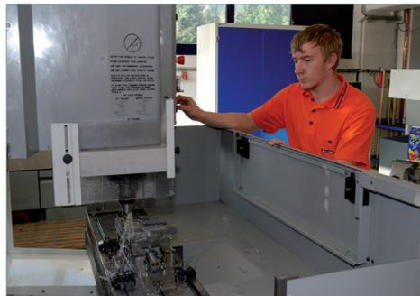
Herstellung der Fräsvorrichtung für die CNC Bearbeitung
